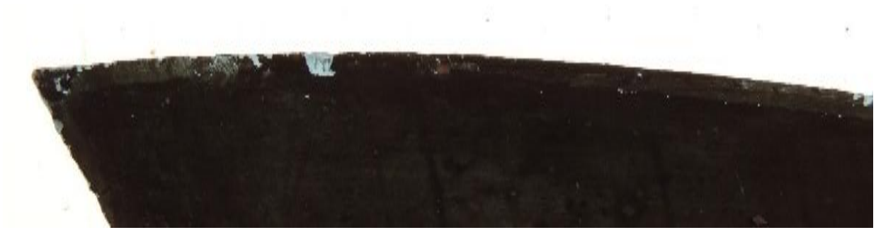
Figur 21, Avskalling av maling i ytterkant av en glassbit grunnet for hardt kitt.
