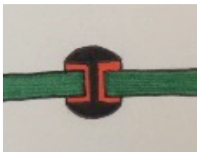
Figur 2, Tverrsnitt; glass er markert med grønt, kitt med rødt og blyet svart
