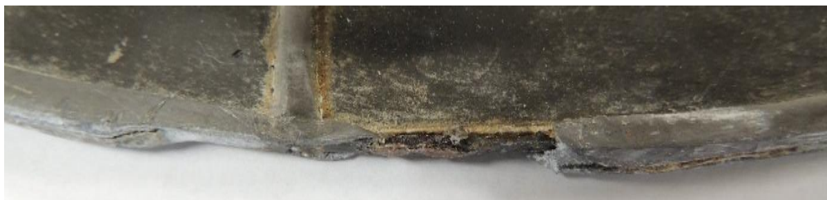
Figur 12, Ytterbly som er blitt delvis skåret bort for å få plass til glassmaleriet i innrammingen.
