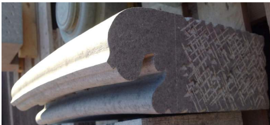
Figur 6. Illustrasjon utforming stein i ytre dekksteinsprofil: Nyhugget stein, DSU4020130.
