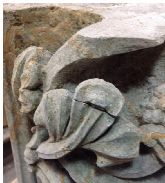
Figur 14. DSU4020550. Rød pil markerer hvor pålimt del hadde løsnet. Til høyre er biten limt på igjen.
