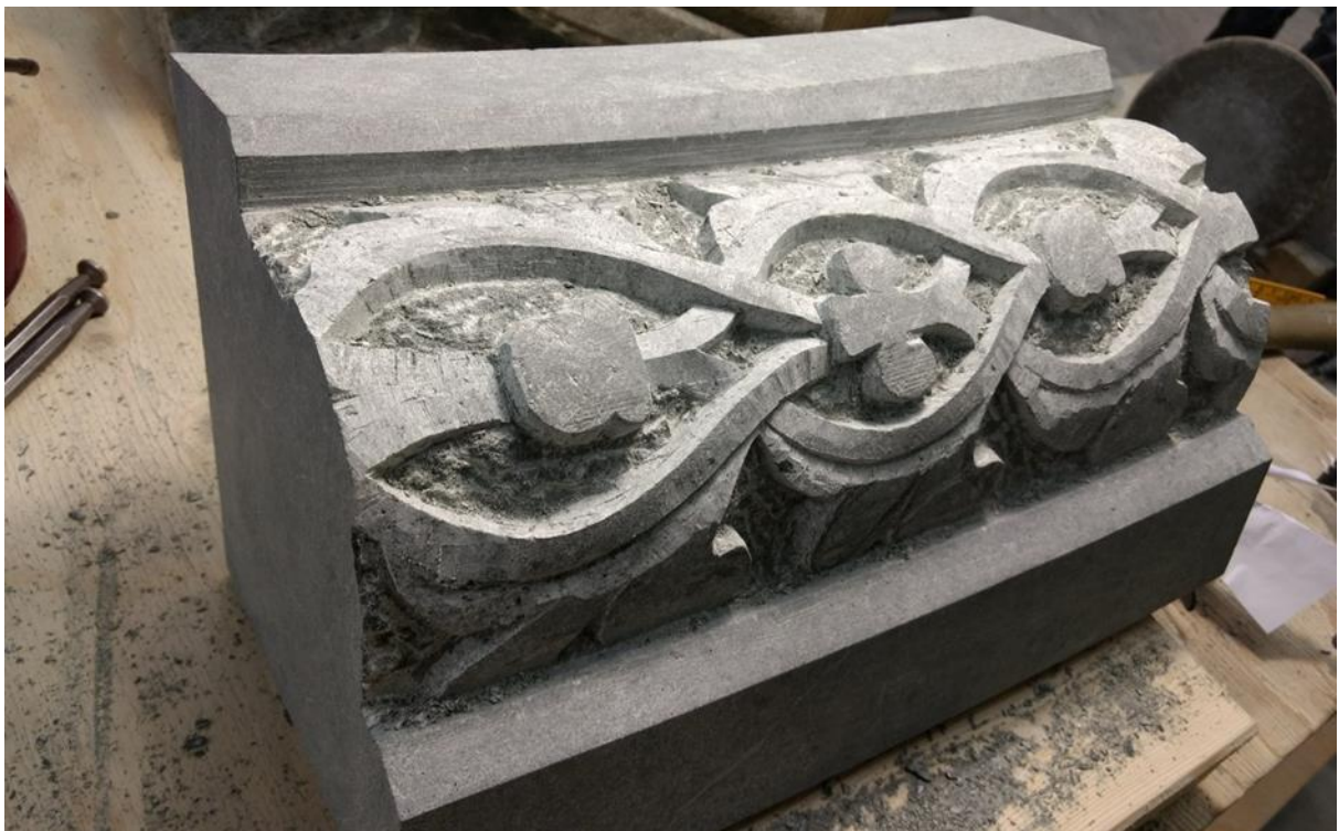
Den grove formen av blad- og flettverket er videre utarbeidet, nærmest til de ønskede dybdepunktene.
