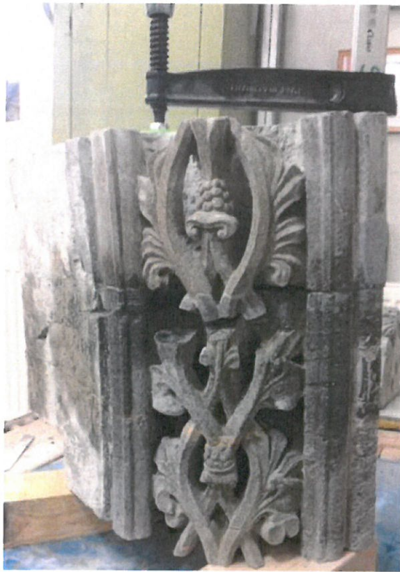
Figur 12. DSU4020390 limt sammen med -0381 (steinene står opp-ned på bildene). Til høyre: Modellering i sammenføyningen mht. styrke. Øvrige mangler betraktes som kosmetiske avvik med liten betydning for helhetsinntrykket.
