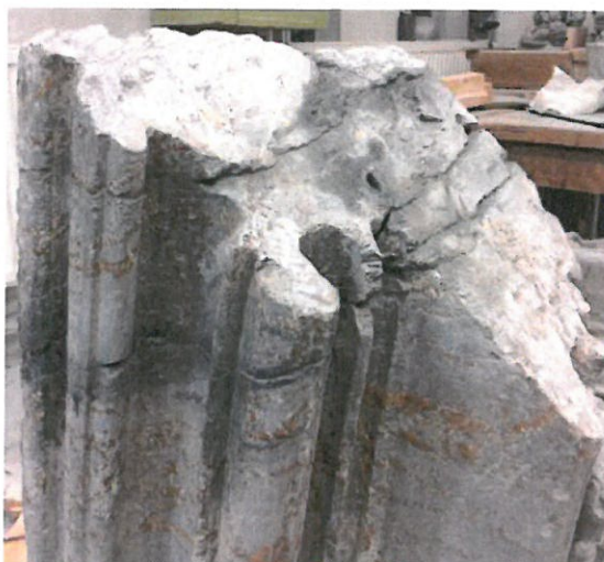
Figur 18. Eksempel på utført sammenliming. Deler i spissen av buen limt på, til venstre sett ovenfra, til høyre fra siden.
