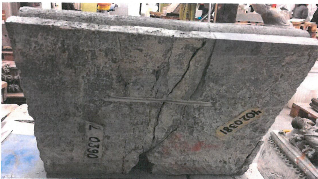
Figur 13. En av krampene påsatt tvers over sprekker på steinens «bakside».
