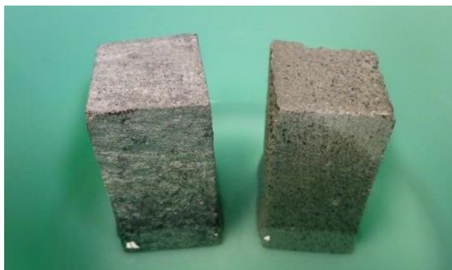
24 Bildet viser hvor fort vannet sprer seg i kleberstein (venstre) og akrylmørtel (høyre) (Foto:NDR)
