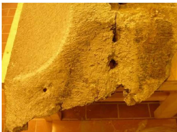
18 Første lag med grov kalkmørtel: kastet på som våt mørtel (foto: Rebecca Reid)
