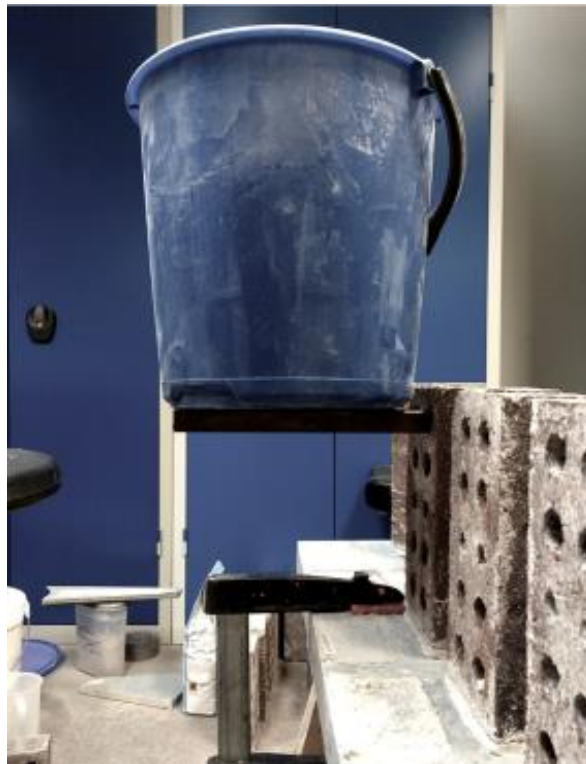
22 Illustrasjonene viser test av heft for kalkbasert mørtel (Foto og figur: NDR)
