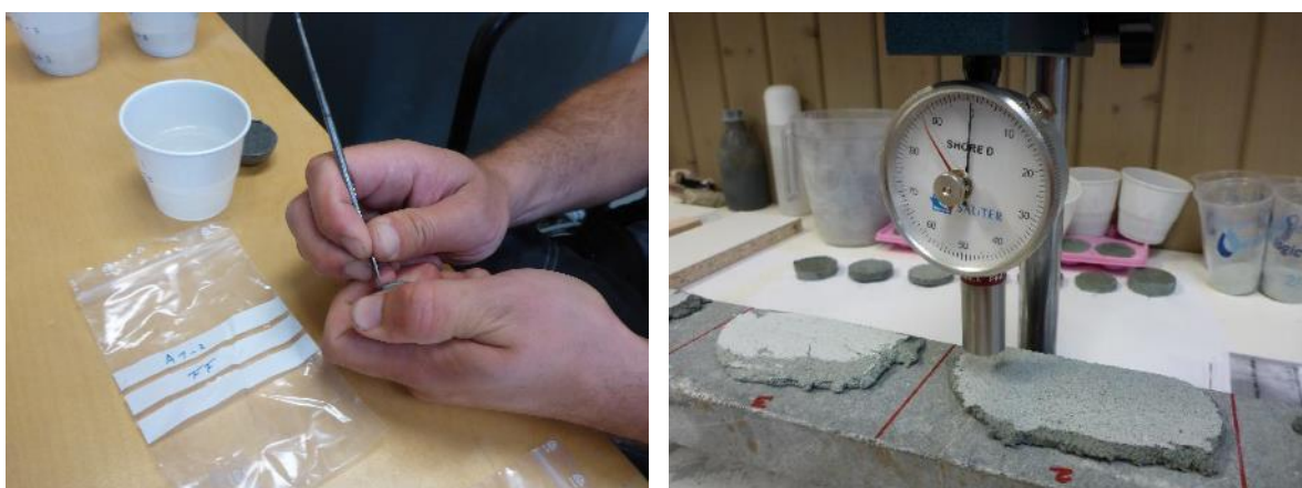
28 Bildene viser hvordan en skrapetest utføres og tester med hardhetsmåleren (Foto: NDR)
