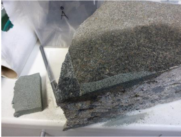
11 Skade på stein, reparasjon testes (foto: NDR)
