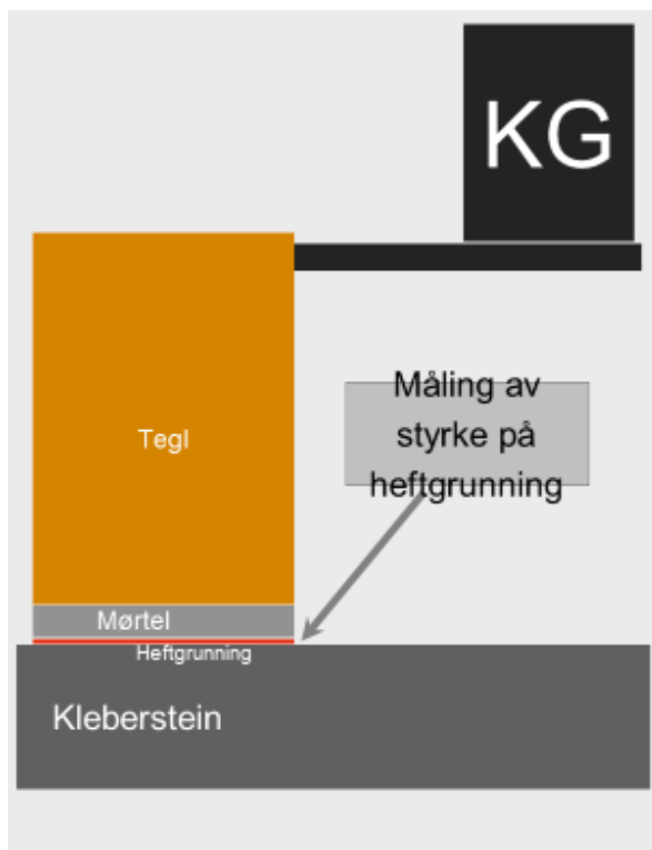
22 Illustrasjonene viser test av heft for kalkbasert mørtel (Foto og figur: NDR)
